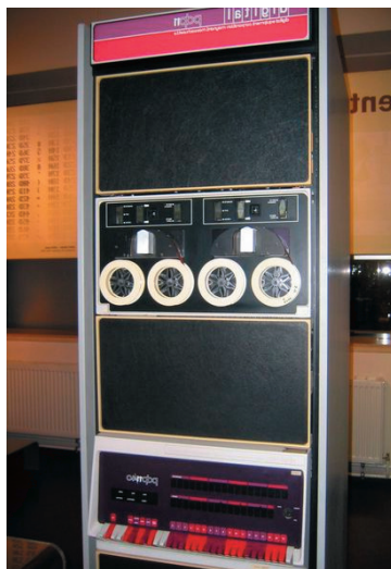
Рис. 4. А вот так выглядел одностоечный мини-компьютер (PDP-11), на котором было две лентопротяжки для работы с магнитными лентами.
