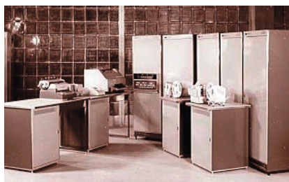
Рис. 2. А вот так выглядел компьютер (это уже была мини-ЭВМ, ибо обходилась минимальным количеством шкафов с электроникой). Здесь изображена советская АСВТ-М6000 (не самая громоздкая и одна из наиболее надежных мини-ЭВМ своего времени)...
